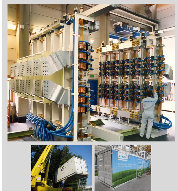
PEM Elektrolyseur (2,1 MW, peak 6,3 MW)
