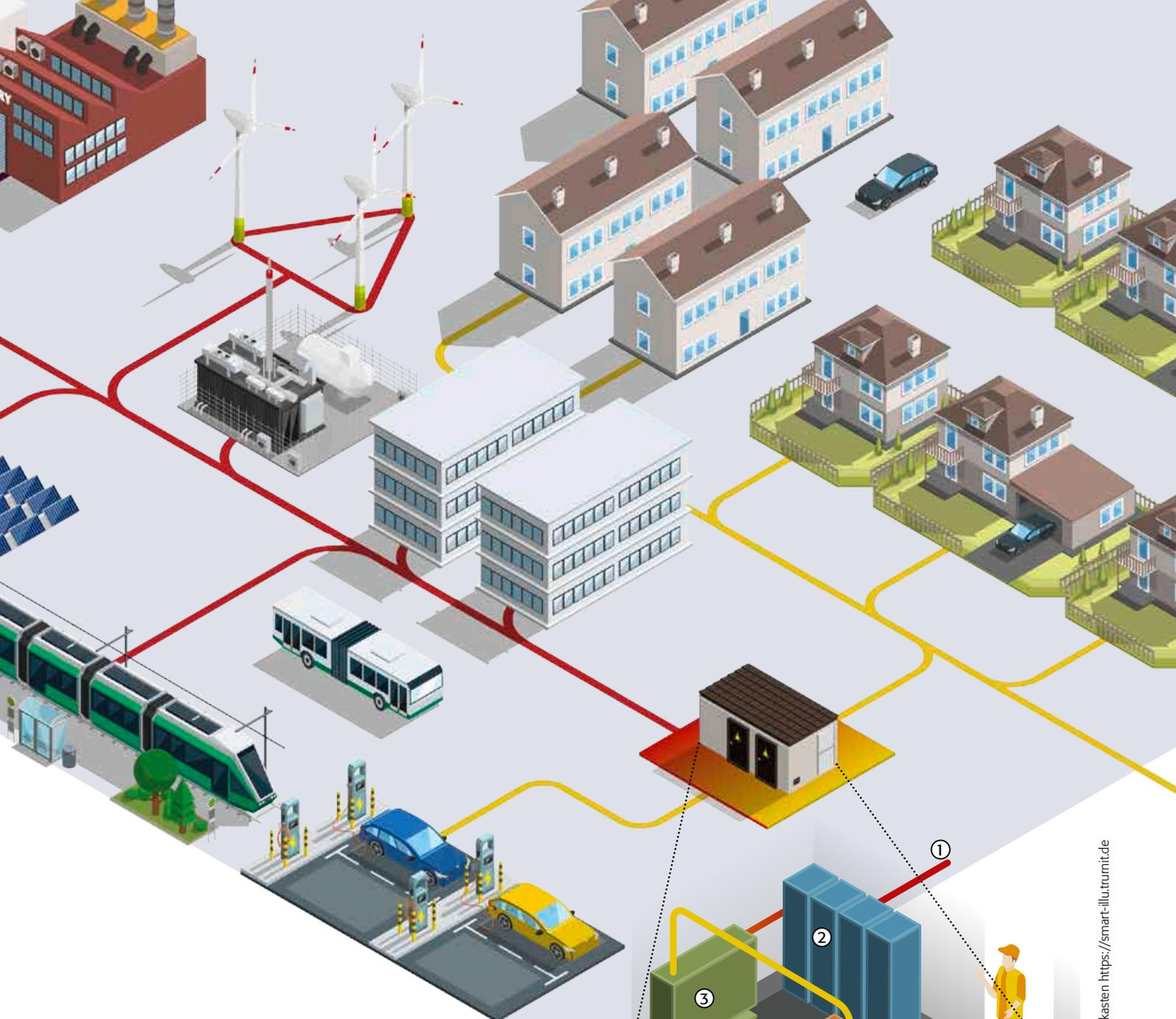
Absenken der Spannung im Netz reduzieren die Netzbetreiber die Energieverluste beim Transport. Hohe Spannung bedeutet kleine Stromstärken und die wiederum lassen die Leitungen nicht heiß werden.
