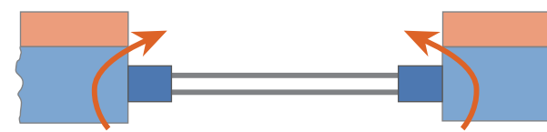
Konstruktionsbedingte Wärmebrücke mit seitlich entweichendem Wärmestrom
